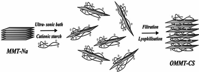
图 2 阳离子淀粉改性 MMT 示意图
